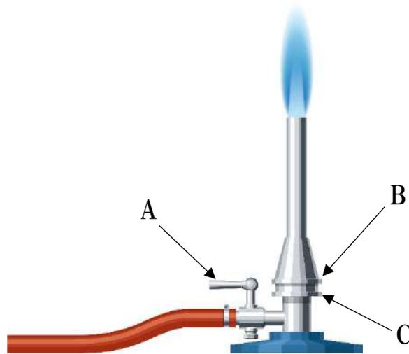
( A:コック ) ( B:空気調節ねじ ) ( C:ガス調節ねじ )
