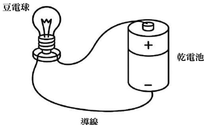
( (A):乾電池 ) ( (B):導線 ) ( (C):豆電球 )
