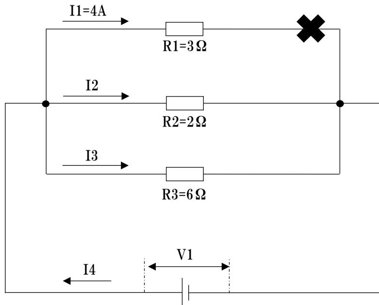
(1) 抵抗 $R_1$ と抵抗 $R_2$ と抵抗 $R_3$ の合成抵抗 $R_x$ を求めよ。また、合成抵抗 $R_x$ を求めるために用いた式を書け。( 式: ) ( 合成抵抗 $R_x$ : )(2) 電池の電圧 $V_1$ を求めよ。また、電圧 $V_1$ を求めるために用いた式を書け。( 式: ) ( 電圧 $V_1$ : )(3) 抵抗 $R_2$ を流れる電流 $I_2$ を求めよ。また、電流 $I_2$ を求めるために用いた式を書け。( 式: ) ( 電流 $I_2$ : )(4) 抵抗 $R_3$ を流れる電流 $I_3$ を求めよ。また、電流 $I_3$ を求めるために用いた式を書け。( 式: ) ( 電流 $I_3$ : )(5) 回路全体に流れる電流 $I_4$ を求めよ。また、電流 $I_4$ を求めるために用いた式を書け。( 式: ) ( 電流 $I_4$ : )(6) 図の×の位置で導線が切れた。この場合の電流 $I_4$ の値を求めよ。また、電流 $I_4$ を求めるために用いた式と計算の途中式を書け。
