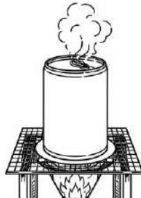
アルミニウム缶には、大気圧による力がはたらいている。加熱する前のアルミニウム缶では、アルミニウム缶の内部の空気によって同じ大きさの力がはたらいているため、アルミニウム缶はつぶれない。
